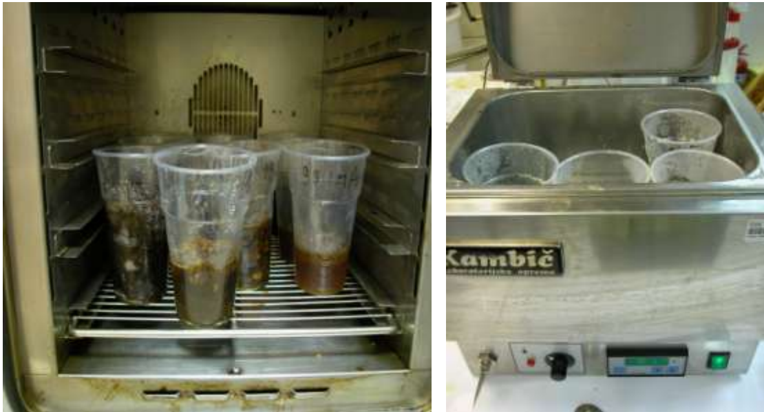
Slika 3: Topljenje voska v toplotni komori in vodni kopeli
