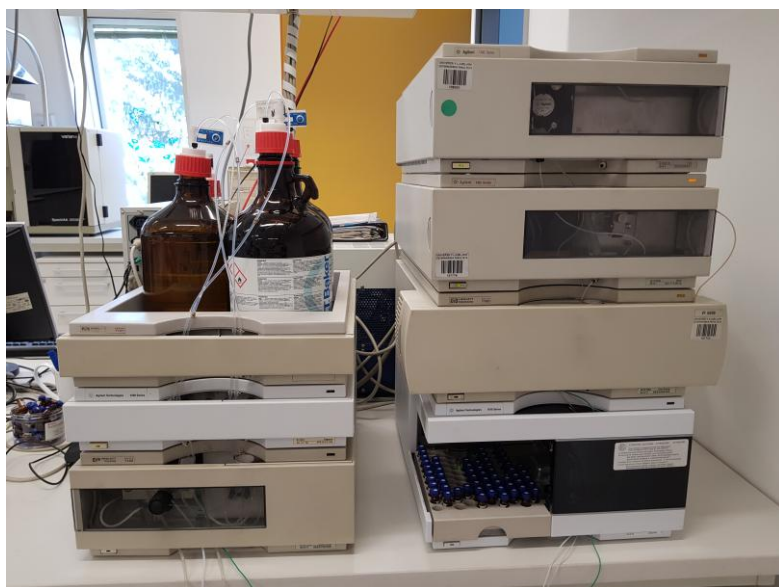
Slika 7: HPLC-FLD med analizo vzorcev medu na sulfonamide
